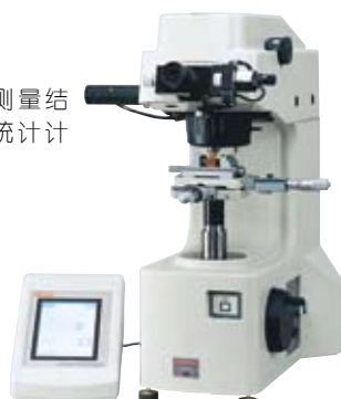
HM-113 监视器可减少人眼测量的个体差异。统计计算功能缩短操作时间
