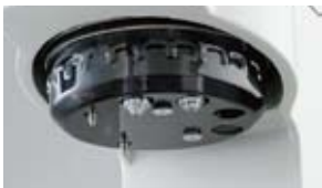
装有2个压头管和4个物镜管的电动旋转盘。 (可进行手动操作)
